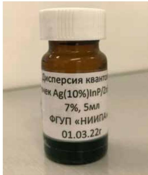
Рис. 4. Фото 2-оболочечной КТ типа Ag(10%):InP/ZnS MPA в транспортном контейнере (неактивное состояние)
