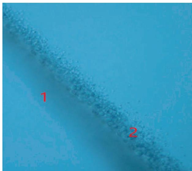
**Рис. 4.** Поперечный срез ИОЛ в области наибольшего помутнения: 1) материал ИОЛ; 2) кристаллиты на поверхности гидрофильного материала ИОЛ
